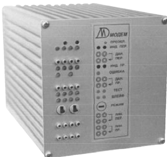
Двухканальный комплекс совмещенной передачи речи и данных ТФМ-3М/2-1Д для работы на одно направление на базе двухканальной платы Мультимодема-100/2400 2КД (исполнение ГК)
