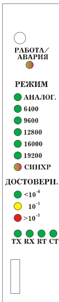
Рис. 6.3.2. Лицевая панель блока генератора и энергонезависимой памяти
