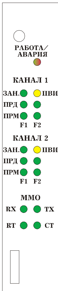
Рис. 6.4.2. Лицевая панель блока абонентского комплекта
