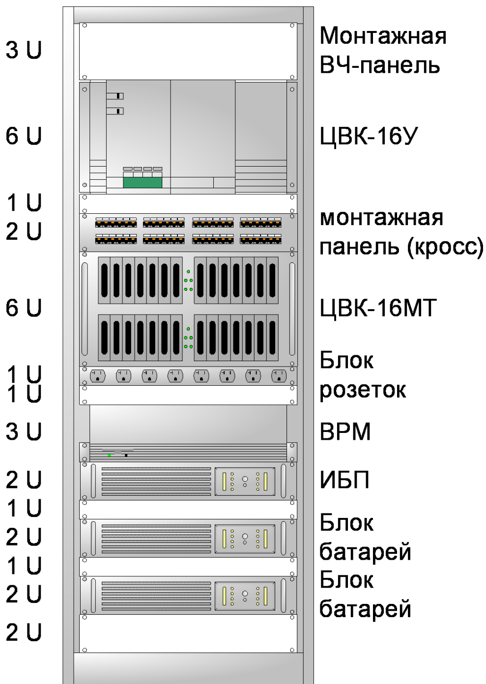
Рисунок 15-4. Схема расположения аппаратуры в 19'-шкафу 33U с VRM, монтажными панелями (опция), органайзером 1U (опция) и источником бесперебойного питания и двумя блоками батарей (опция).
