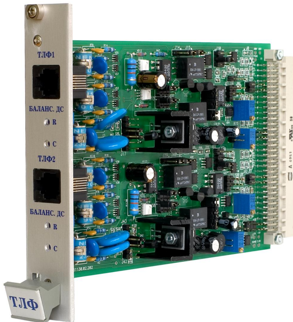
Рисунок 6.8.1 – Внешний вид блока интерфейсов телефонных окончаний с элементами балансировки R и C на лицевой панели.
