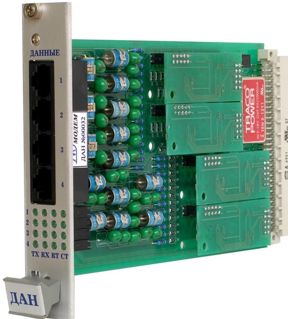
Рисунок 6.10.1 – Внешний вид блока интерфейсов каналов передачи данных межмашинного обмена или телемеханики
