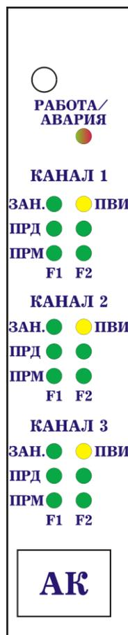
Рисунок 6.4.3 – Лицевая панель блока абонентских каналов
