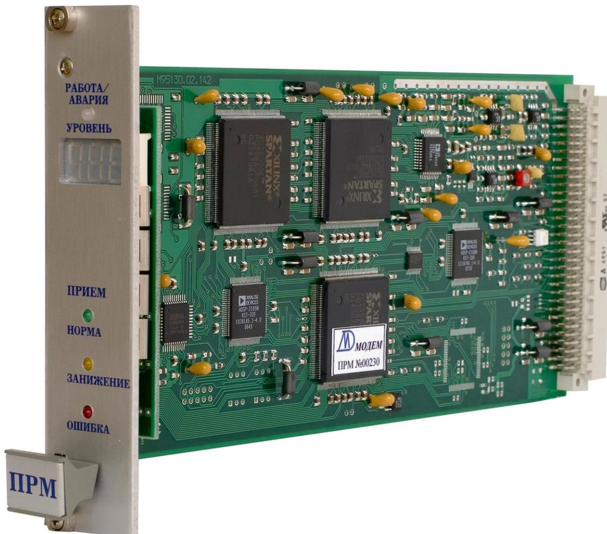
Рисунок 6.2.2 – Внешний вид блока приемника
