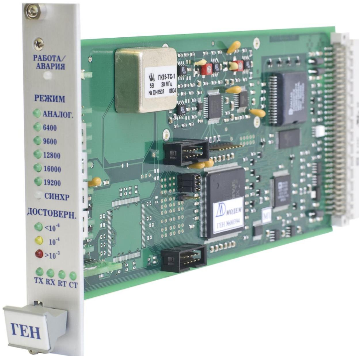
Рисунок 6.3.1 – Внешний вид блока генератора и энергонезависимой памяти
