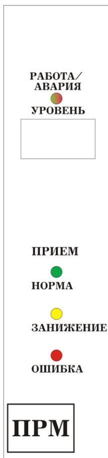
Рисунок 6.2.3 – Лицевая панель блока приемника
