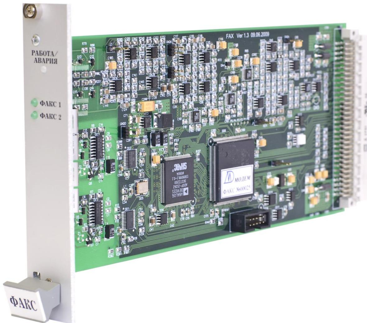
Рисунок 6.7.2 – Внешний вид блока факсимильных интерфейсов
