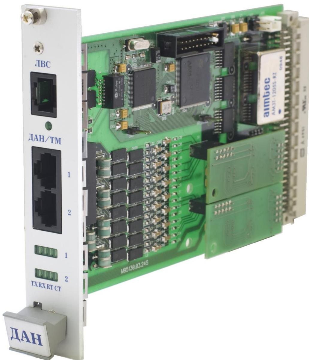
Рисунок 6.10.2 – Внешний вид блока ДАН (тип 2) интерфейсов Ethernet и канала передачи данных
