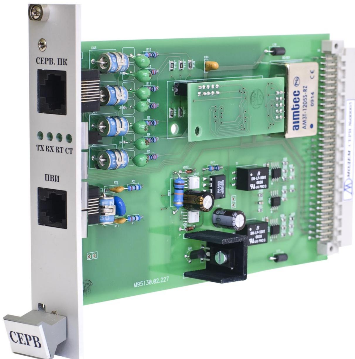
Рисунок 6.11.1 – Внешний вид блока интерфейса сервисного ПК
