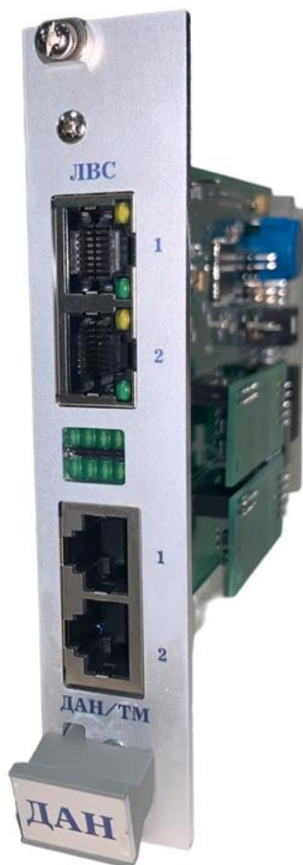
Рисунок 6.11.3 – Внешний вид блока ДАН (тип 3) интерфейсов Ethernet и каналов передачи данных ММО/ТМ
