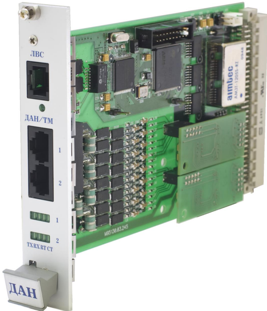
Рисунок 6.11.2 – Внешний вид блока ДАН (тип 2) интерфейсов Ethernet и каналов передачи данных ММО/ТМ
