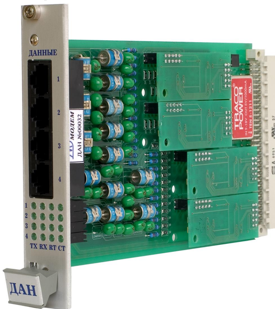
Рисунок 6.11.1 – Внешний вид блока ДАН (тип 1) интерфейсов каналов передачи данных межмашинного обмена или телемеханики
