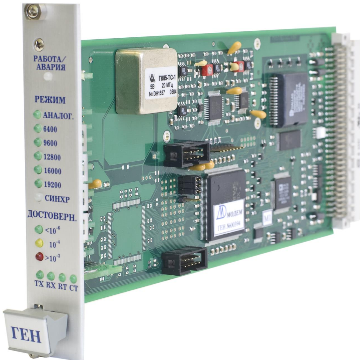
Рисунок 6.3.1 – Внешний вид блока генератора и энергонезависимой памяти
