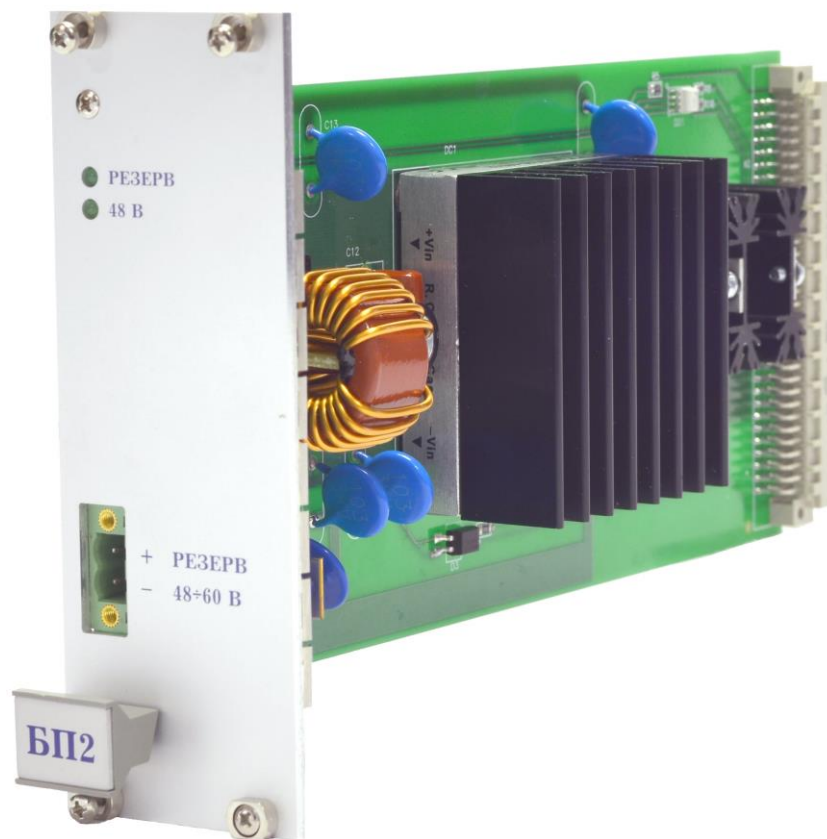
Рисунок 6.13.4 – Внешний вид блока БП2 для комплекта №3 (с резервным вводом питания)
