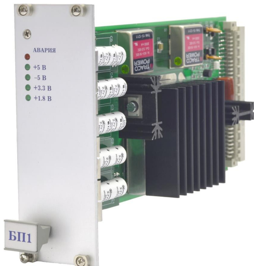
Рисунок 6.13.2 – Внешний вид блока БП1 для комплекта №3 (с резервным вводом питания)
