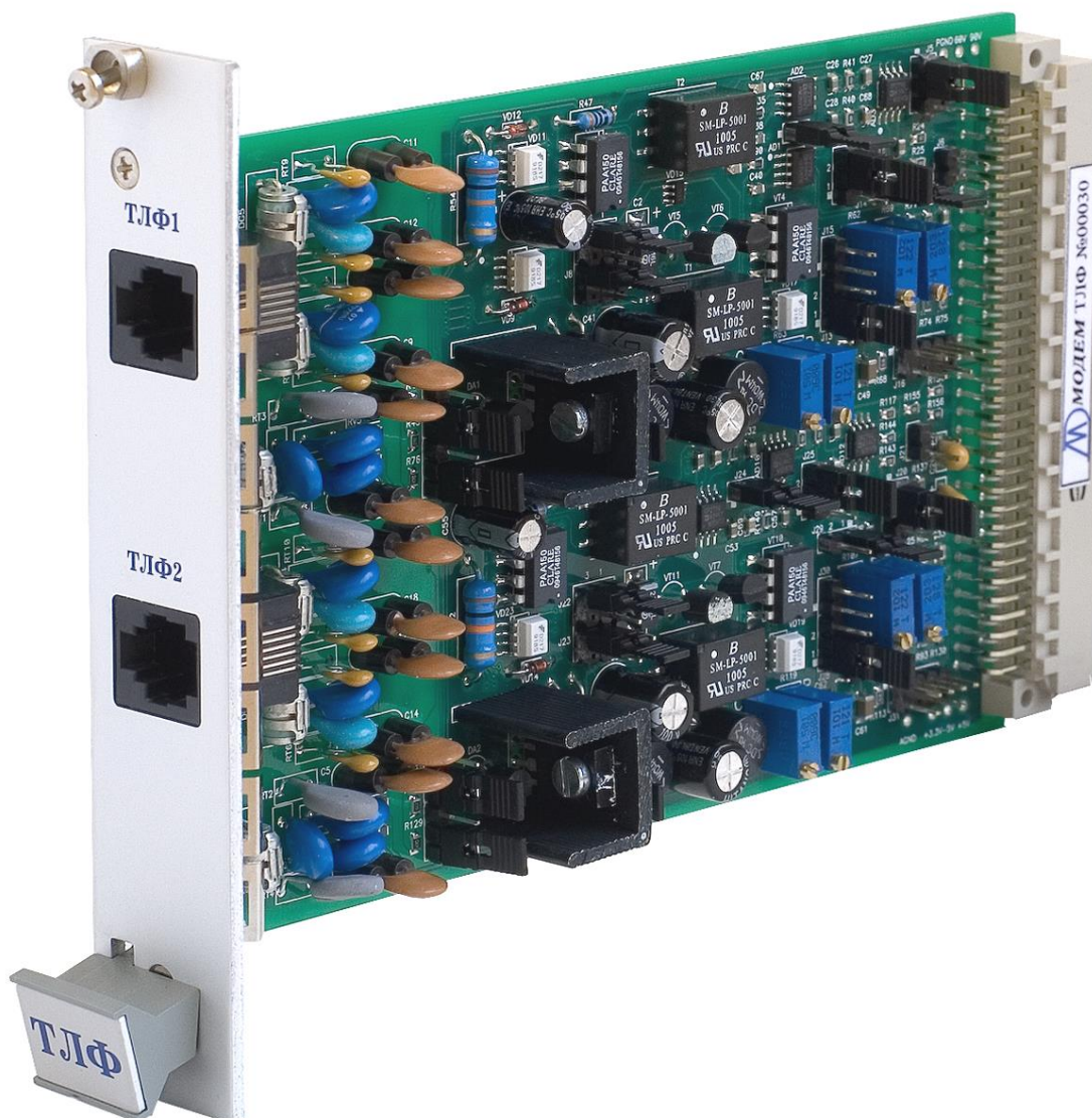
Рисунок 6.8.2 – Внешний вид блока интерфейсов телефонных окончаний с элементами балансировки R и C внутри блока.
