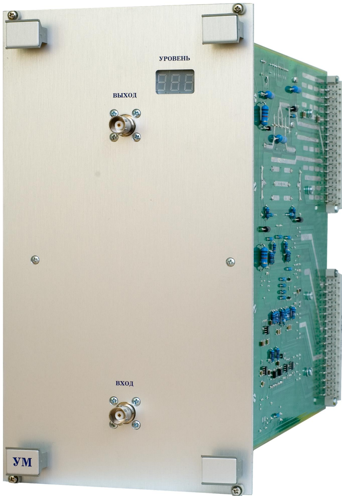
Рисунок 3.2.1 – Внешний вид блока усилителя мощности
