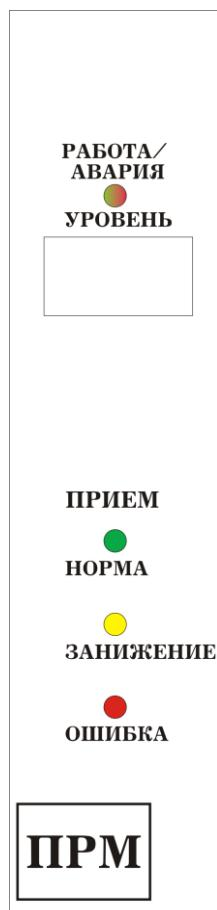
Рисунок 6.2.3 – Лицевая панель блока приемника
