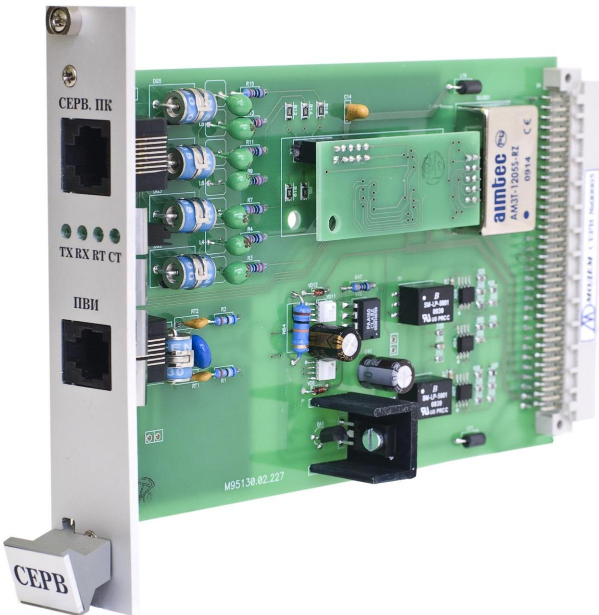
Рисунок 6.11.1 – Внешний вид блока интерфейсов сервисного ПК и ПВИ
