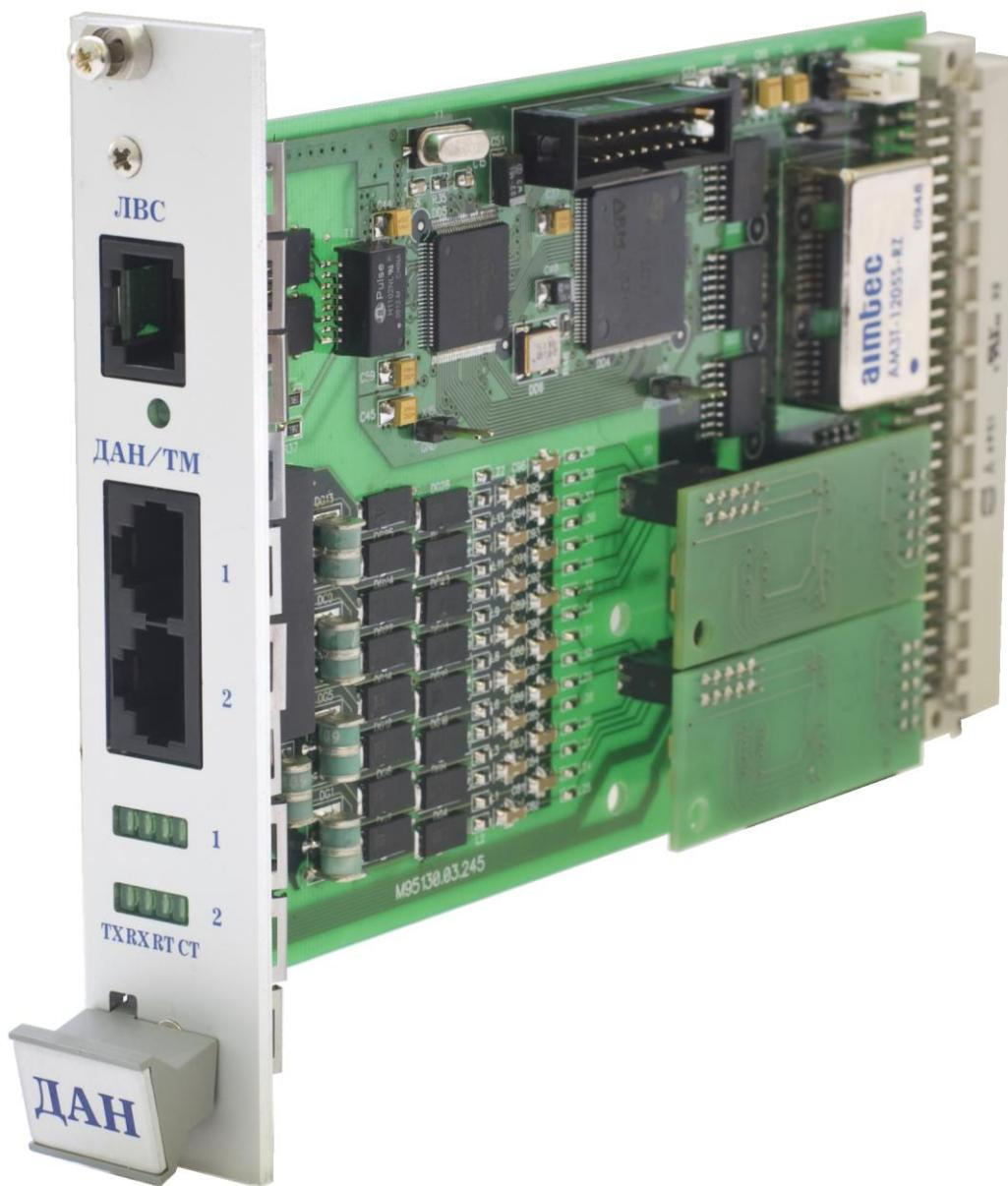
Рисунок 6.10.1 – Внешний вид блока интерфейсов Ethernet и канала передачи данных
