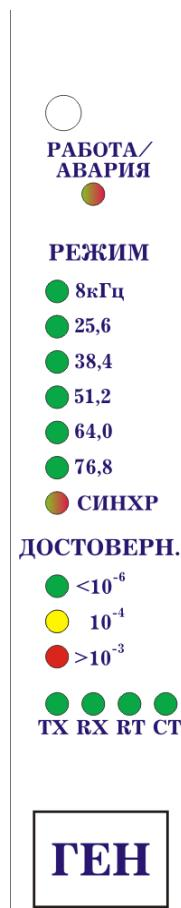
Рисунок 6.3.3 – Лицевая панель блока генератора и энергонезависимой памяти
