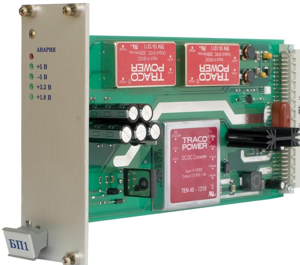
Рисунок 6.12.1 – Внешний вид блока БП1
